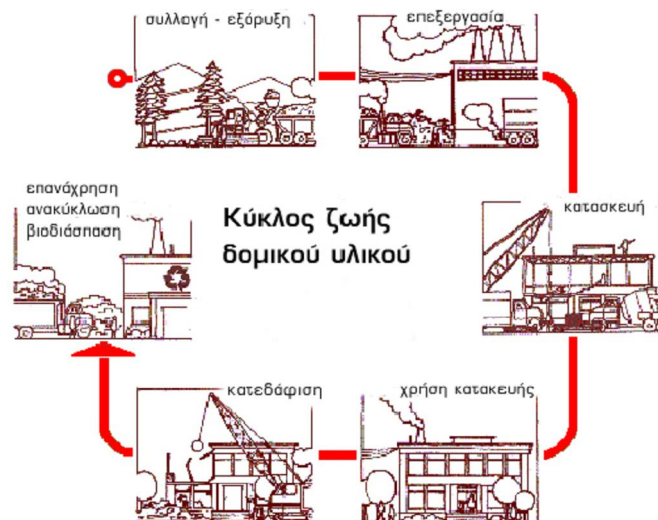
Εικ. 2.4:: Διάγραμμα ροής του κύκλου ζωής ενός δομικού υλικού [20]
