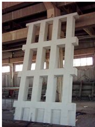
Εικ. 3.3: Στοιχείο όψης Νέου Μουσείου Ακρόπολης (επιφανειακή προκατασκευή) [71]
