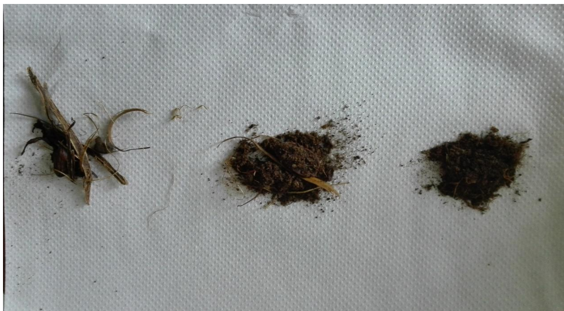
Εικόνα 14: Αριστερά βρίσκεται το χονδρόκοκκο κλάσμα του FORBI, στη μέση το FORBI χωρίς κάποια επεξεργασία και δεξιά το λεπτόκοκκο κλάσμα του FORBI
