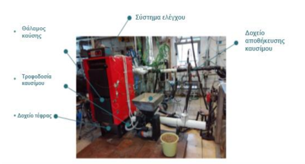
Εικόνα 24: Πειραματική διάταξη καύσης των πέλλετς
