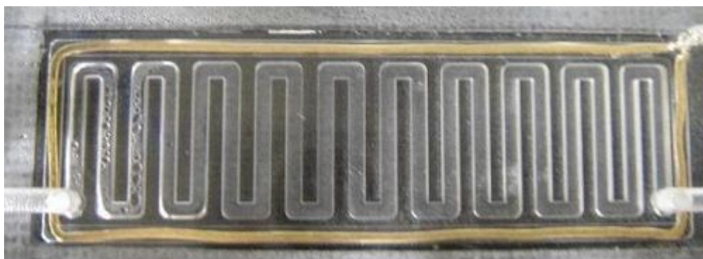
Σχήμα 3.5 Κανάλια για την ροή του αέρα- νερού σε μία πλάκα γραφίτη.
