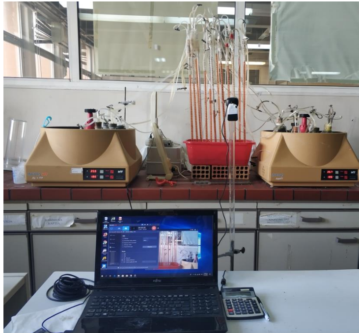
Εικόνα 3.1. Γυάλινο μπουκάλι (αντιδραστήρας batch) συνδεδεμένο με προχοΐδα (A) και συνολική πειραματική διάταξη αναερόβιας χώνευσης (B)
