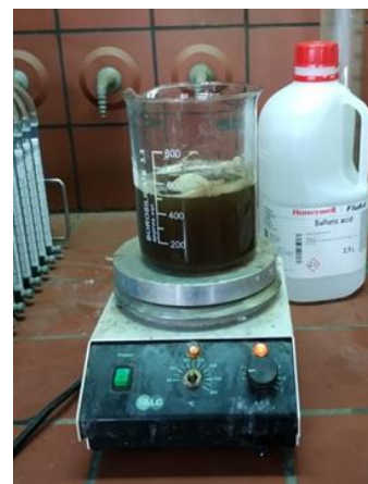
Εικόνα 3.2 Δείγμα στραγγισμάτων σε μαγνητικό αναδευτήρα κατά την επεξεργασία με χημική οξείδωση Fenton
