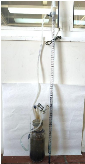
Εικόνα 3.1. Γυάλινο μπουκάλι (αντιδραστήρας batch) συνδεδεμένο με προχοΐδα (A) και συνολική πειραματική διάταξη αναερόβιας χώνευσης (B)
