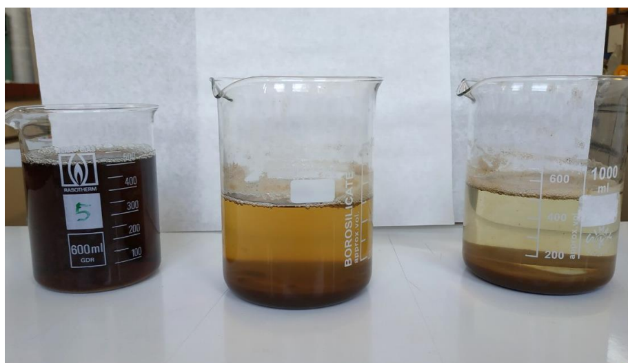
Εικόνα 4.1 Αρχικό απόβλητο (αριστερά), απόβλητο μετά από Fenton χωρίς προσθήκη NaOH και κροκιδωτικού (στη μέση) και απόβλητο μετά από Fenton με προσθήκη NaOH και κροκιδωτικού (δεξιά)
