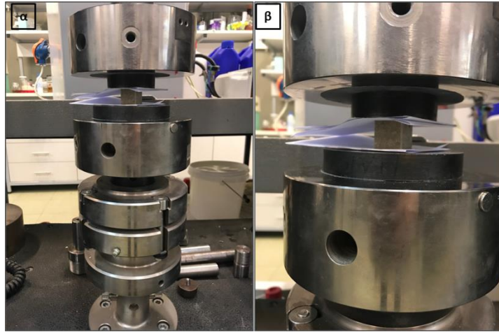
Εικόνα 11 – Συσκευή θλίψης INSTRON
