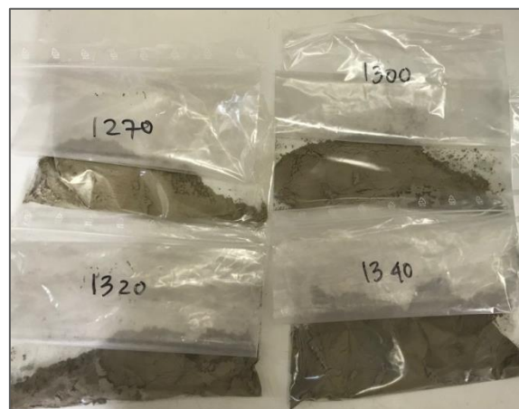
Εικόνα 7 – Τα τέσσερα διαφορετικά κλίνκερ που παράχθηκαν με την έψηση στους 1270, 1300, 1320 και 1340°C μετά την διαδικασία της άλεσης.
