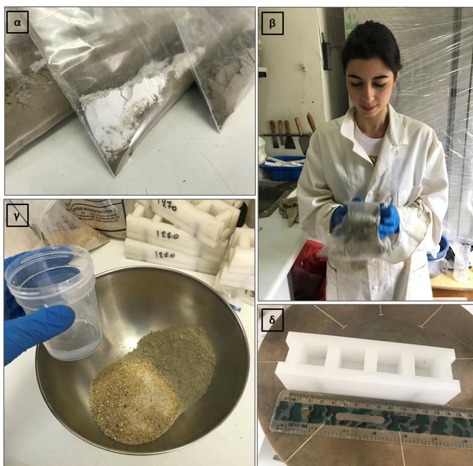
Εικόνα 8 – (α) Ανάμιξη του κλίνκερ με τη γύψο, (β) ομογενοποίηση του μίγματος γύψου-κλίνκερ, (γ) ανάμιξη των αδρανών (άμμου) με το τσιμέντο και το νερό, (δ) μήτρα διαστάσεων 2x2x2cm 3 για σύνθεση δοκιμίων.
