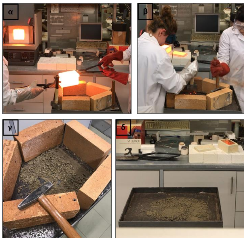
Εικόνα 6 - (α) Το κλίνκερ τη στιγμή που ολοκληρώνεται η διαδικασία της έψησης, (β) ψύξης του κλίνκερ (γ,δ) το τελικό προϊόν της έψησης (κλίνκερ), πριν την άλεση.
