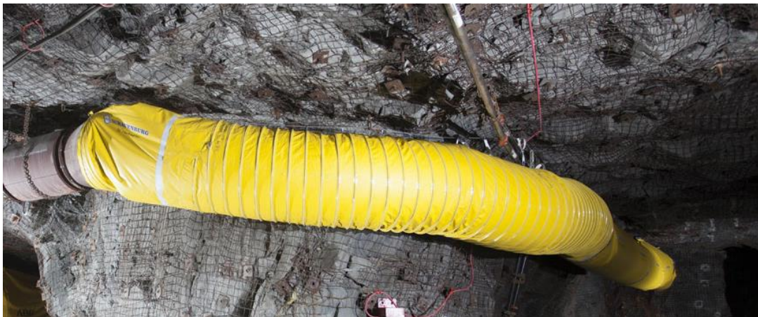
Εικόνα 3.18 : Εύκαμπτος αγωγός με σπειροειδή ελατήριο
