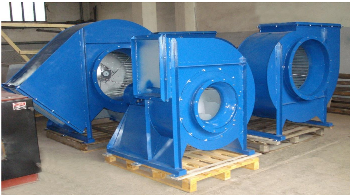
Εικόνα 3.3 : Φυγοκεντρικοί ανεμιστήρες σε μεταλλείο στο Μαντούδι Ευβοίας ("ΤΕΡΝΑ ΛΕΥΚΟΛΙΘΟΙ Α.Ε")
