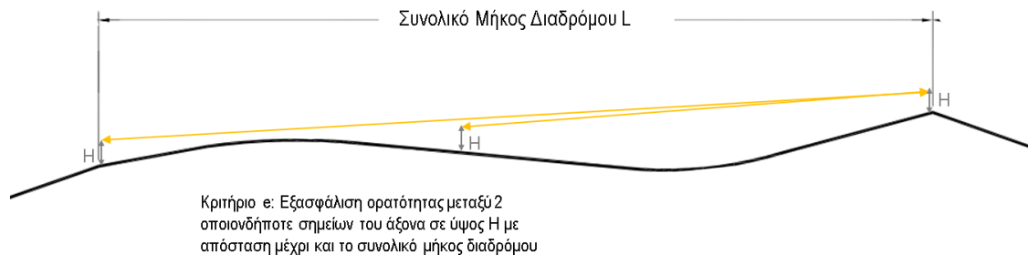
Σχήμα 3.8: Κριτήριο ορατότητας σε περίπτωση όπου δεν υπάρχει παράλληλος τροχόδρομος
