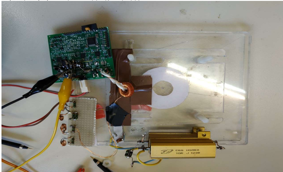
Σχήμα 5.11: Πειραματική διάταξη συστήματος με ενισχυτή κλάσης E.
