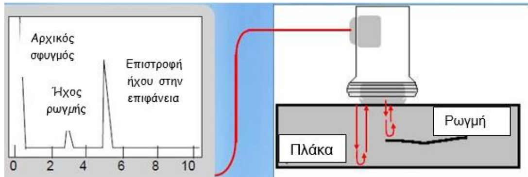
Σχήμα 6.6: Απεικόνιση υπερηχητικού ελέγχου (UT)
