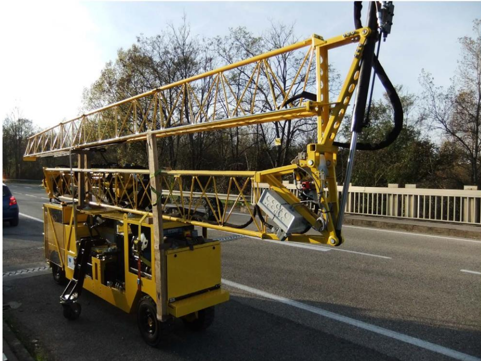
Σχήμα 3.13: Ρομποτικό σύστημα επιθεώρησης
