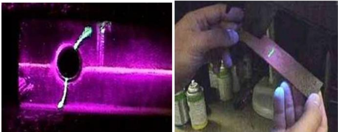
Σχήμα 6.3: Έλεγχος πληρωμένων με φθορίζον υλικό ρηγματώσεων, υπό υπεριώδη UV ακτινοβολία
