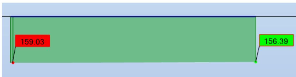
Σχήμα 11.92: Διάγραμμα ροπών M_y εγκάρσιας δοκού
