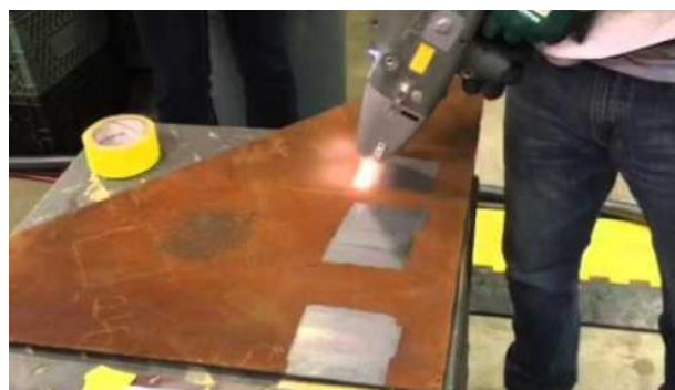
Σχήμα 10.2: Καθαρισμός σκουριάς με laser
