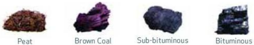
Σχ. 1.1.β: Είδη γαιανθράκων: Τύρφη- Καφετί άνθρακας- Υποβιτουμενιούχος – Βιτουμενιούχος, (Πηγή: World Coal Institute, "What is coal")
