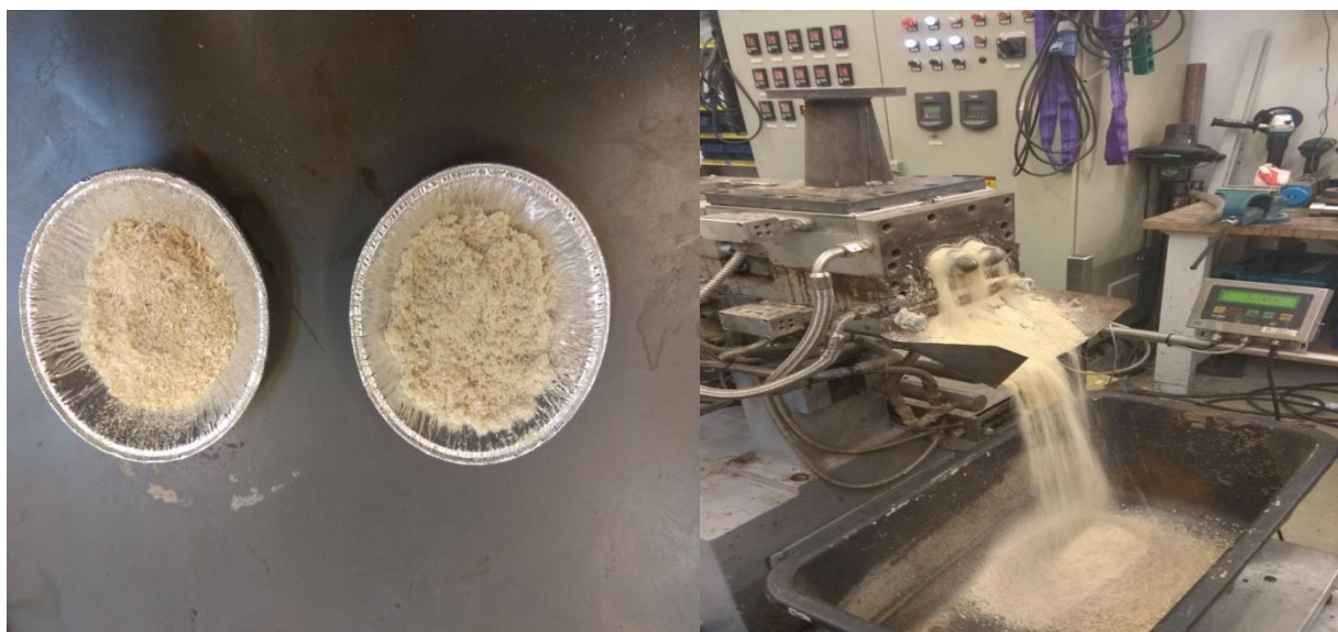
Εικ.14 Πριονίδι Πεύκου Πριν και Μετά τον Εκβολέα (Αριστερά), Διεργασία Εκβολής (Δεξιά)
