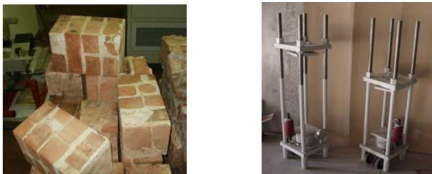
Εικόνα 2.11 Δοκίμια και μηχανές ερπυσμού
