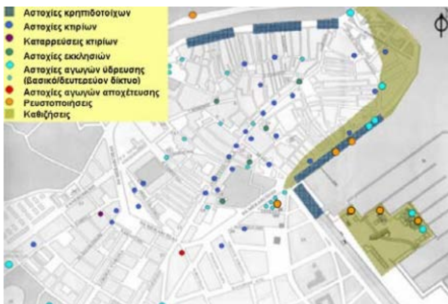
Σχήμα 6.15: Κατανομή αστοχιών στο δίκτυο ύδρευσης/αποχέτευσης στο ιστορικό κέντρο της Λευκάδας, Μ.Αλεξούδη, Κ. Κακδέρη, Κ. Πιτιλάκης, 2006.
