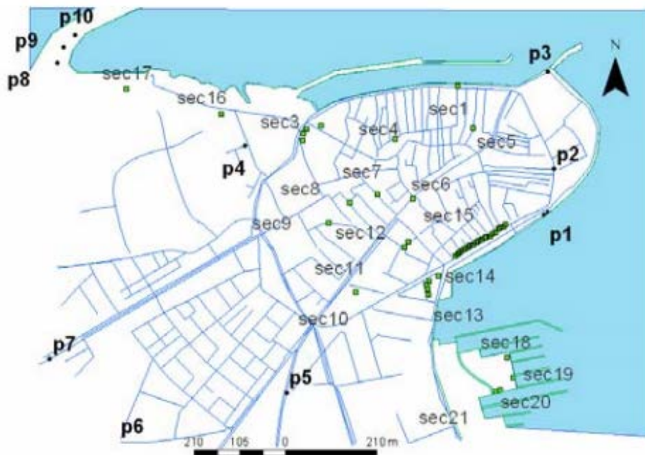
Σχήμα 6.17: Καταγεγραμμένες αστοχίες του βασικού και του δευτερεύοντος δικτύου ύδρευσης (Σύμβολα: p- βασικό δίκτυο, sec- συνδέσεις καταναλωτών), Μ.Αλεξούδη, Κ. Κακδέρη, Κ. Πιτιλάκης, 2006.
