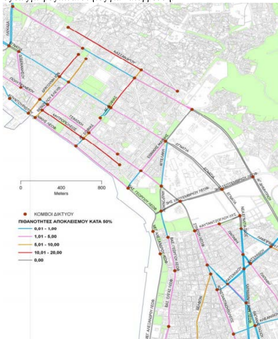
Σχήμα 8.6: Χωρική κατανομή της πιθανότητας υπέρβασης αποκλεισμού οδών κατά 50% του ενεργού πλάτους για το σεισμικό σενάριο με T_m=475 χρόνια, Σ. Αργυρούδης, Κ. Πιτιλάκης, Θ. Χατζηγώγος, 2008.
