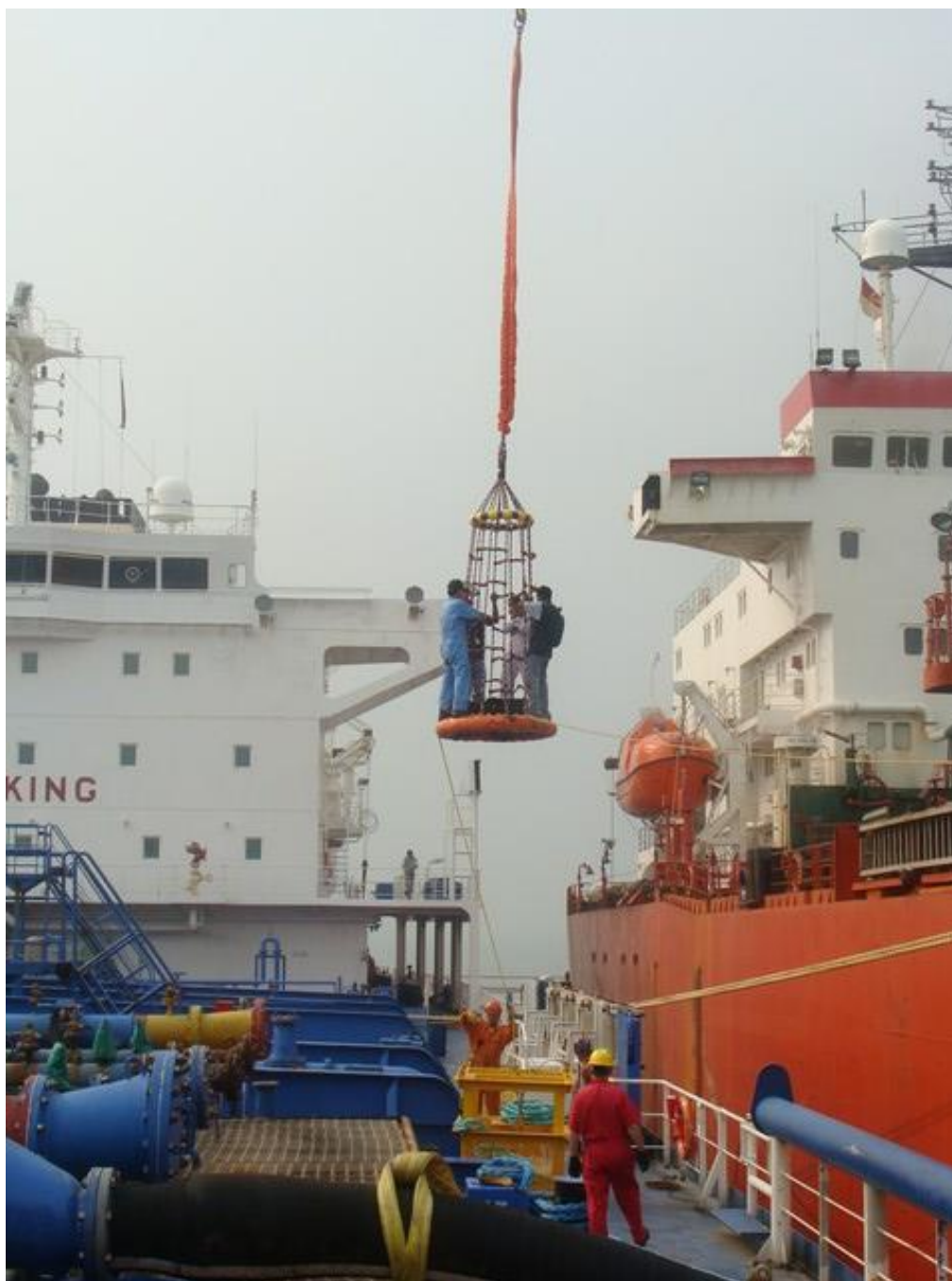
Εικόνα 4-2: Μεταφορά προσωπικού μέσω γερανών σε διαδικασία εναλλαγής φορτίου. [ http://teakdoor.com/indonesia-forum/82153-a-few-days-offshore-indonesia.html ]
