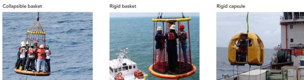
Εικόνα 4-3: Είδη καλάθιων κατά την μεταφορά προσωπικού από ένα πλοίο σε άλλο [Marine Transfer Forum, 2016]
