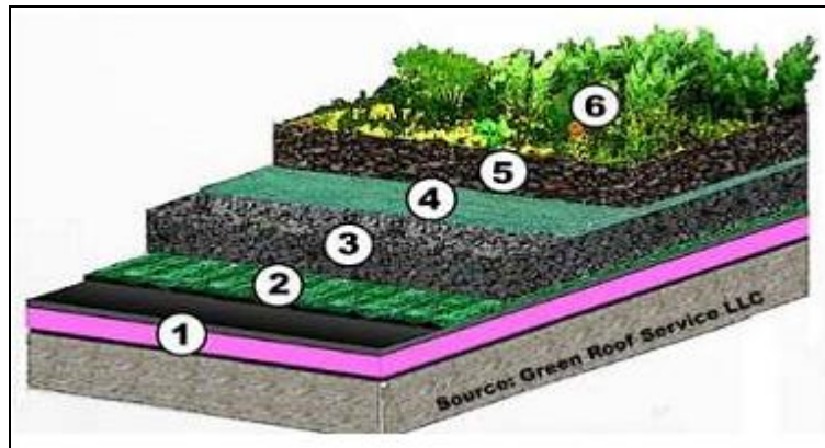
Εικ. Στάδια κατασκευής φυτεμένου δώματος
