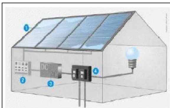
Φ/Β σύστημα: 1.Φ/Β πλαίσια-2.Πίνακας ελέγχου-3.Αντιστροφέας(inverter)-4.Μετρητής
