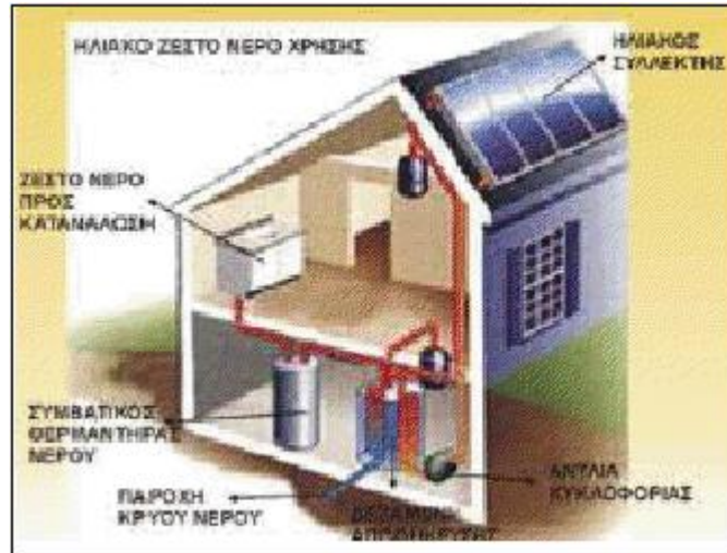
Ολική εγκατάσταση ζεστού νερού
