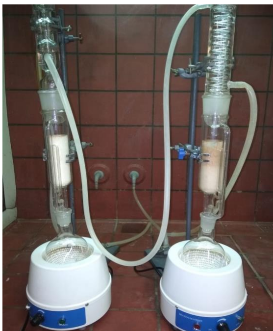
Εικόνα 7.4 Συμβατική διάταξη Soxhlet
