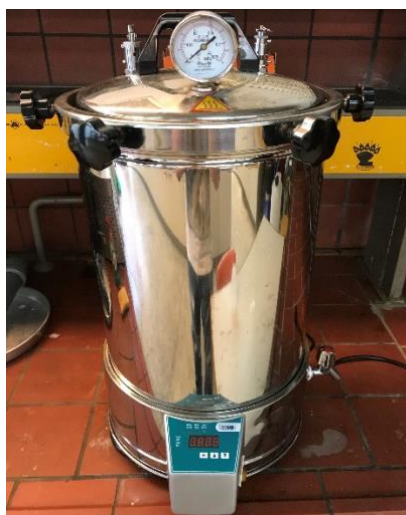
Εικόνα 8.8: Κλίβανος αποστείρωσης ISOLAB Laborgerate GmbH Autoclave
