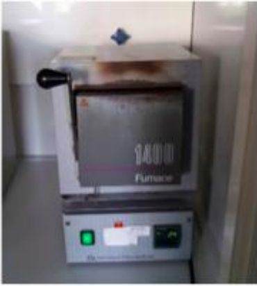
Εικόνα 7.7 Φούρνος μέτρησης πτητικών στερεών
