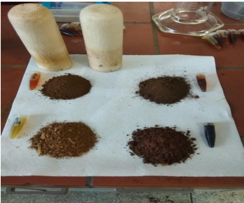
Εικόνα 6.1 Τέσσερα έλαια με το στερεό υπόλειμμα τους, δύο για κάθε πρώτη ύλη (ένα με εξάνιο και ένα με μεθανόλη) (πάνω τα δείγματα από καφέ, στα αριστερά χρήση εξανίου ως διαλύτη)
