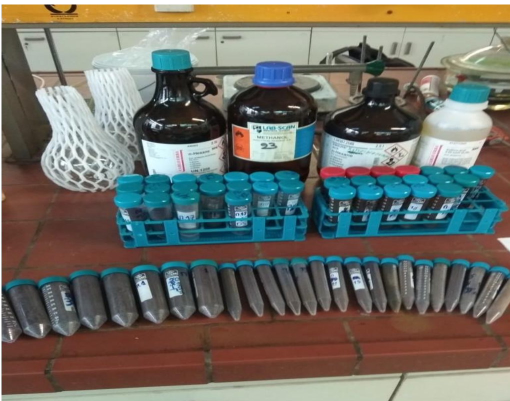
Εικόνα 7.5 Δείγματα στερεών υπολειμμάτων μετά την εκχύλιση των λιπών και των ελαίων τους.
