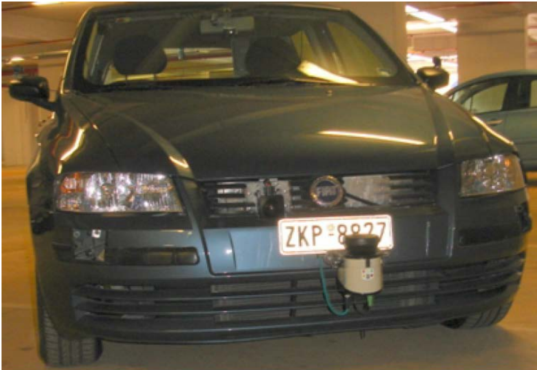
Εικόνα 3.1: Πειραματικό αυτοκίνητο με το λέιζερ LMS151
