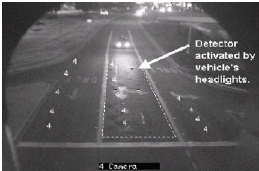
Εικόνα 3-8: Η διαγραμμισμένη περιοχή αποτελεί κατά τον ανιχνευτή ένα κινούμενο όχημα (Μουσούλης, 2005).
