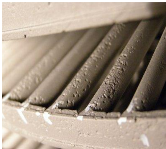
Σχήμα 6.3 Μηχανική διάβρωση πτερύγωσης στροβίλου
