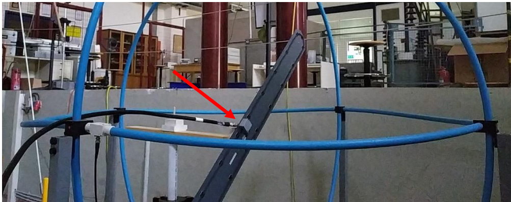
Εικόνα 4-15: Σύνδεση ομοαξονικού καλωδίου 50 Ω στο δίπολο επαλήθευσης της LLA
