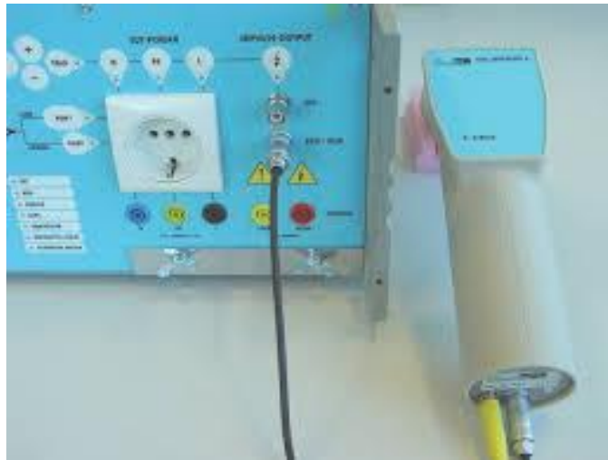
Εικόνα 5-7: Γεννήτρια ηλεκτροστατικής εκφόρτισης EMC Partner EXT-TRA3000 E
