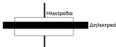
Εικόνα 6: Δημιουργία πυκνωτή από το δοκίμιο και δύο μεταλλικά ηλεκτρόδια – τεχνική DRS
