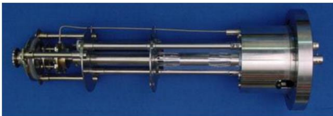
Εικόνα 5: Η κυψελίδα όπου τοποθετείται ο πυκνωτής με το προς μέτρηση δοκίμιο
