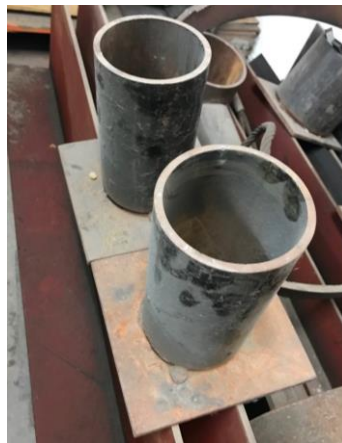
Σχήμα 2.14: Οι κορμοί της βάσης πριν διαμορφωθούν
