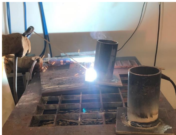
Σχήμα 2.18: Συγκόλληση του κορμού
