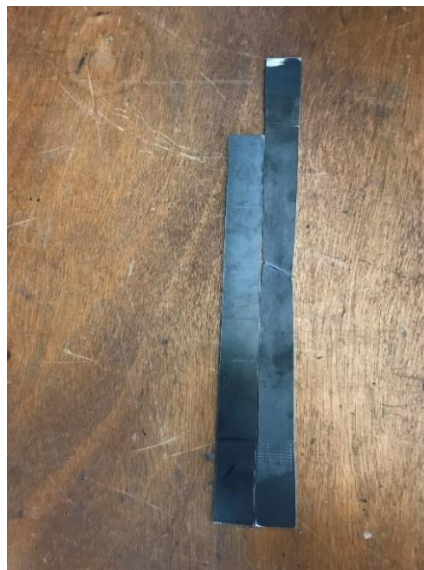
Σχήμα Π.7: Άθικτο δοκίμιο (αριστερά)- Δοκίμιο που έχει υποβληθεί σε πειραματική δοκιμή(δεξιά)
