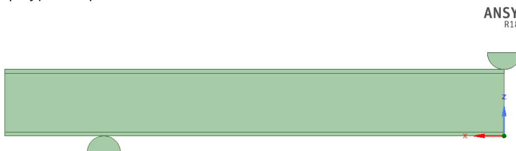
Σχήμα 4.7: Πλάγια όψη των roller και pusher σε σχέση με τη δοκό διατομής IPE
