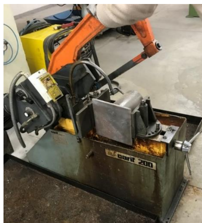
Σχήμα 2.16: Ο κορμός της βάσης στο υδραυλικό σιδηροπρίονο
