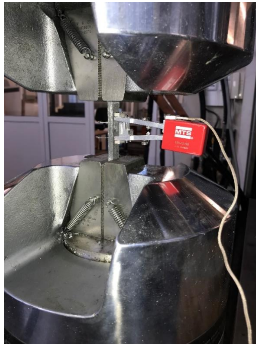
Σχήμα Π.3: Πειραματική διάταξη πειράματος εφελκυσμού
