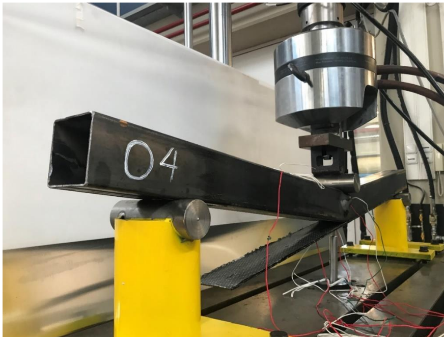
Σχήμα 3.17: Το δοκίμιο O4 μετά την αποκόλληση του επιθέματος
