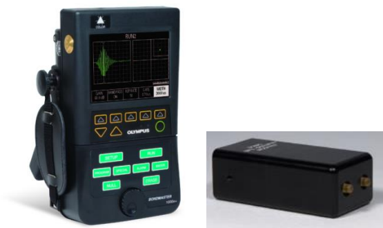
Σχήμα 3.36: Συσκευή BondMaster 1000e+ και κεφαλή Pitch - Catch.
