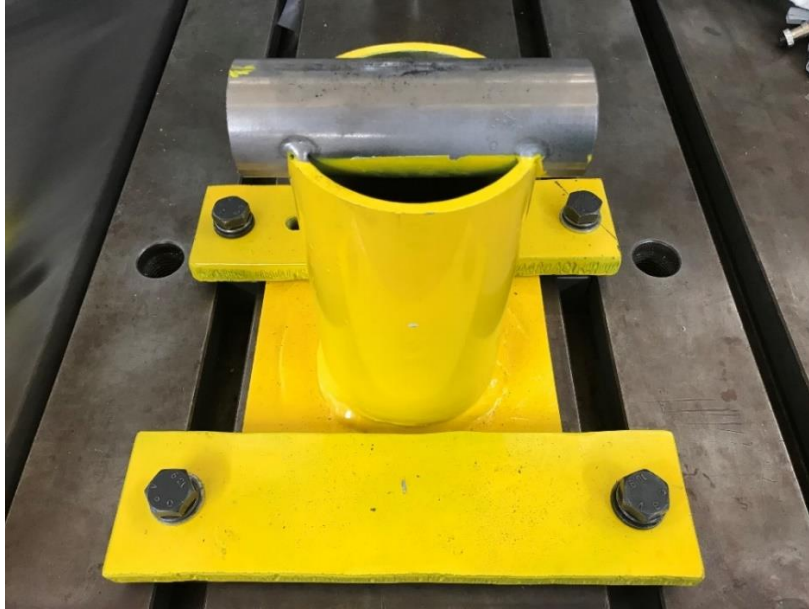
Σχήμα 2.12: Η βάση της πειραματικής διάταξης συναρμολογημένη στην τράπεζα της μηχανής
