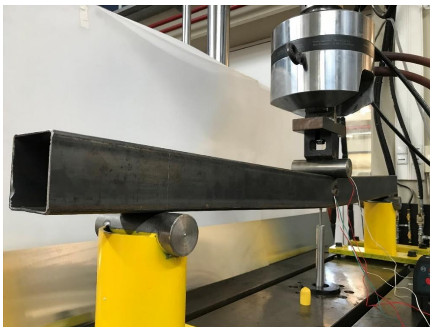
Σχήμα 3.11: Το δοκίμιο Ο Reference στο τέλος της πειραματικής δοκιμής
