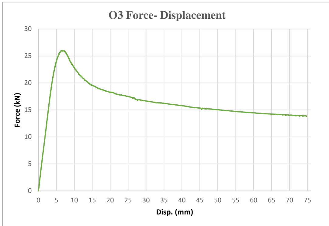
Σχήμα 3.14: Το διάγραμμα δύναμης- βέλους κάμψης για το δοκίμιο O3
