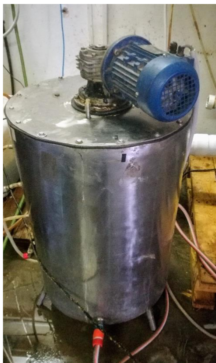
Εικόνα 5. Ο μεσόφιλος αναερόβιος αντιδραστήρας CSTR.
