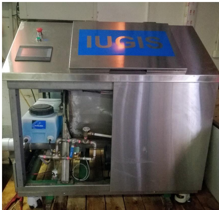
Εικόνα 4. ORCA IUGIS. Κάτω από την πόρτα στην οροφή βρίσκεται ο θάλαμος προκατεργασίας, ενώ όλο το υπόλοιπο αποτελεί το εξωτερικό τμήμα. Στην εικόνα απεικονίζονται το δοχείο με το μπλε διάλυμα μικροοργανισμών (αριστερά) και ακριβώς από κάτω του η ηλεκτροβάννα. Στο πάνω μέρος της μονάδας διακρίνεται η οθόνη ελέγχου, καθώς και τα κουμπιά έναρξης (πράσινο) και έκτακτης παύσης (κόκκινο).
