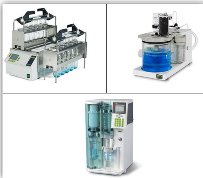
Εικόνα 7. Διάταξη Kjeldahl. Πάνω αριστερά απεικονίζεται η συσκευή χώνευσης SpeedDigester K-425, πάνω δεξιά η συσκευή διαχείρισης απαερίων της χώνευσης Scrubber K-415 και κάτω η συσκευή απόσταξης Kjelflex K-360.
