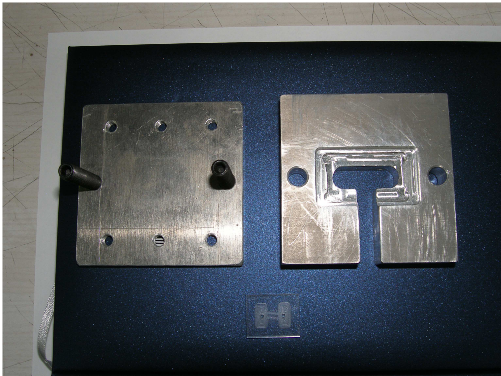
Εικόνα 3.5: Διάταξη μικροκαναλιών και μεταλλική μάσκα
