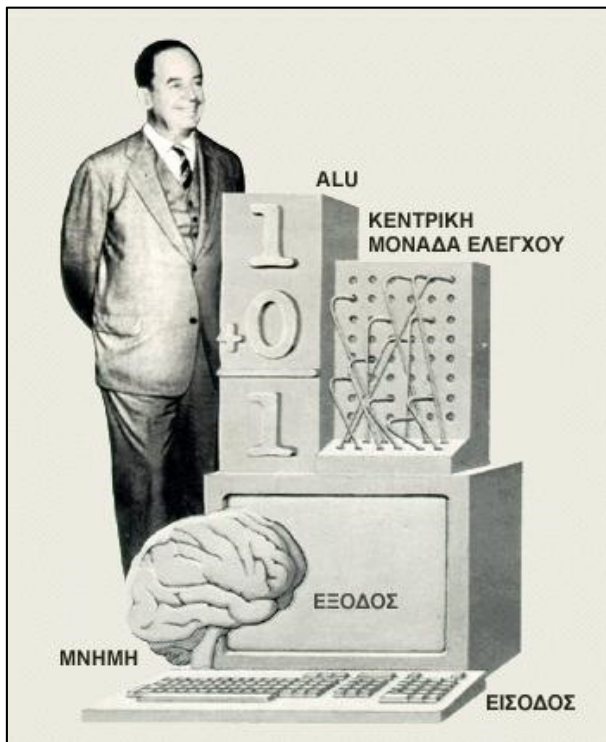
Εικόνα 2. Τα πέντε βασικά στοιχεία, που απαρτίζουν έναν υπολογιστή κατά von Neumann.
