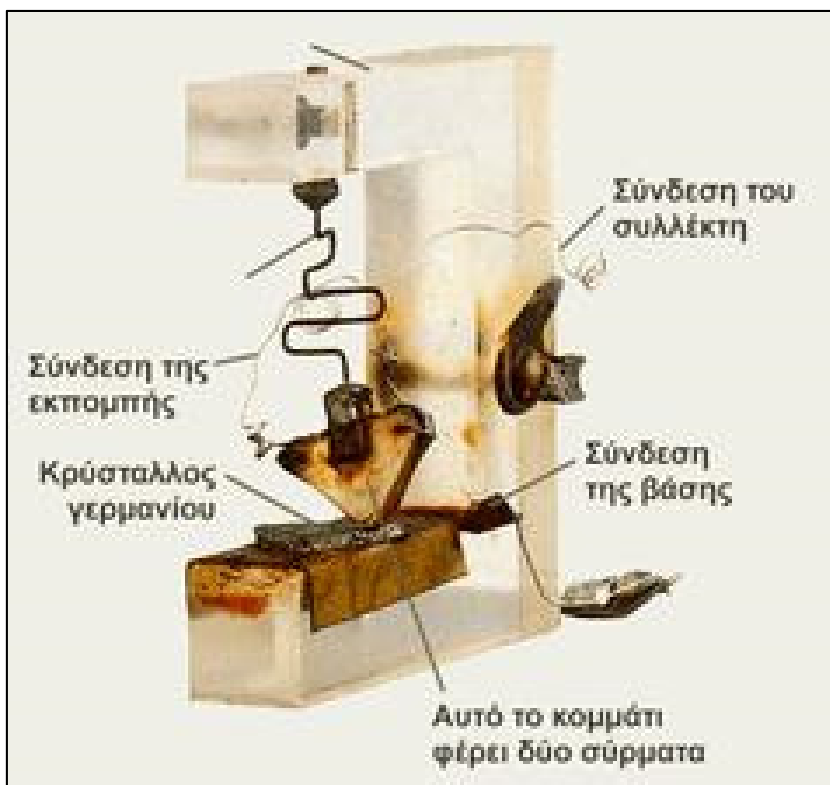
Εικόνα 14. Η συνδεσμολογία του πρώτου τρανζίστορ (1947) 17 .
