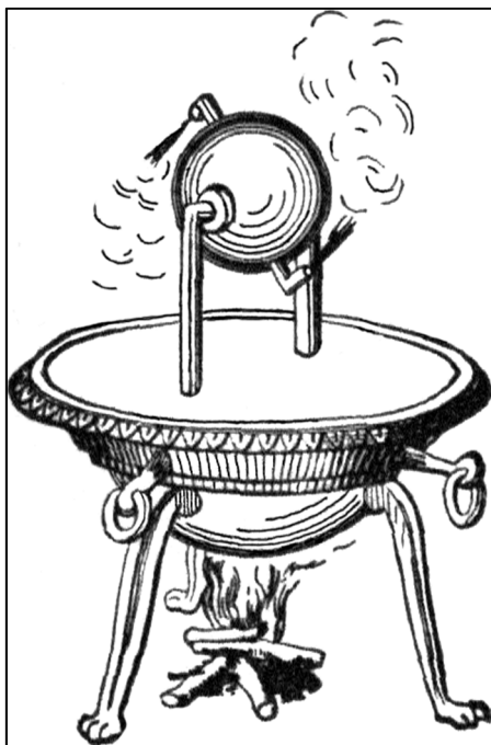
Εικόνα 1. Η αιολόσφαιρα του Ήρωνα.
