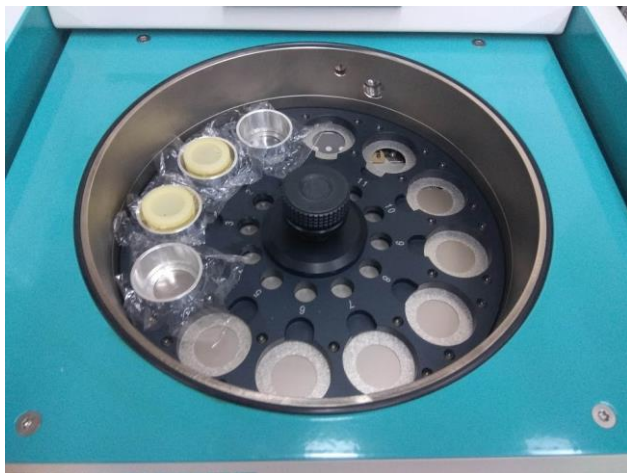
Εικόνα 2-10 Ο δίσκος με τα δείγματα στη συσκευή Spectro Xepos
