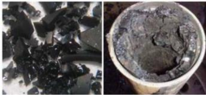
Εικόνα 1-1 Ασφαλτένια. Εργαστηριακό δείγμα ασφαλτενίων αδιάλυτων σε επτάνιο (αριστερά) και εναπόθεμα ασφαλτενίων σε σωληνώσεις (δεξιά). (Mullins)
