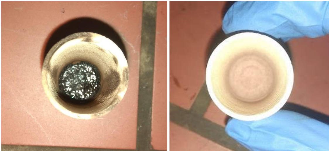
Εικόνα 3-2 Το φίλτρο μετά από εκχύλιση VR με εξάνιο Εικόνα 3-3 Το φίλτρο μετά από εκχύλιση VGO με πεντάνιο
