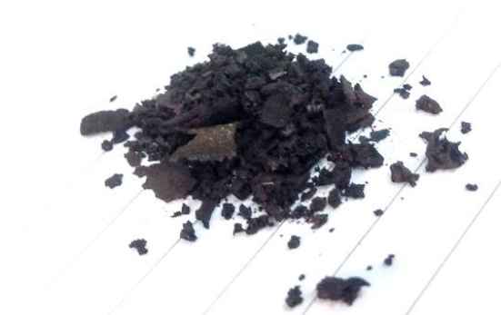
Εικόνα 3-8 Ασφαλτένια από AR με χρήση εξανίου
