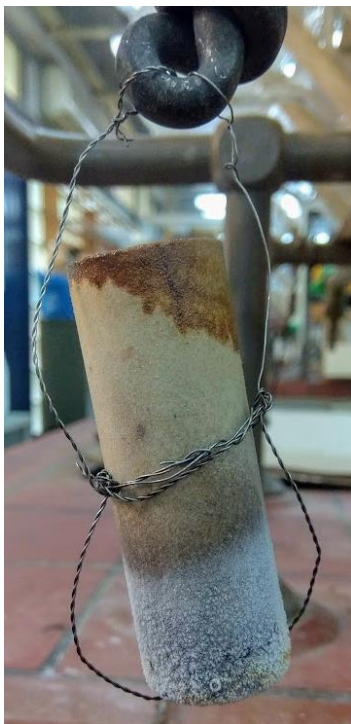
Εικόνα 3-5 Στο φίλτρο έχουν σχηματιστεί χιονονιφάδες
