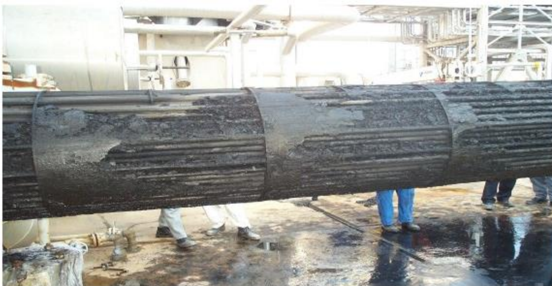
Εικόνα 1-2 Ασφαλτένια έχουν επικαθίσει στον εναλλάκτη (Asphaltenes, 2016)
