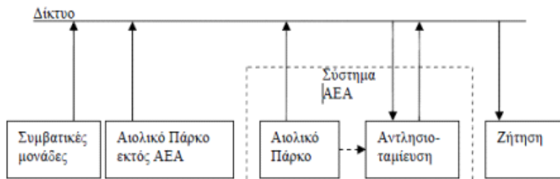
Σχήμα 2.17: Άμεση διασύνδεση αιολικού πάρκου-αντλιοσταμείωσης.[39]
