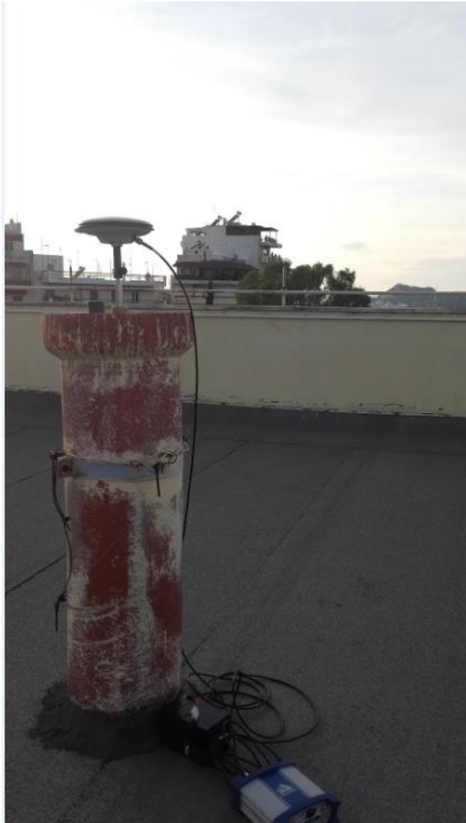
Σχήμα 5.3: Εγκατάσταση Base σε σημείο με γνωστές συντεταγμένες (Πηγή: Φωτογραφία από πεδίο)
