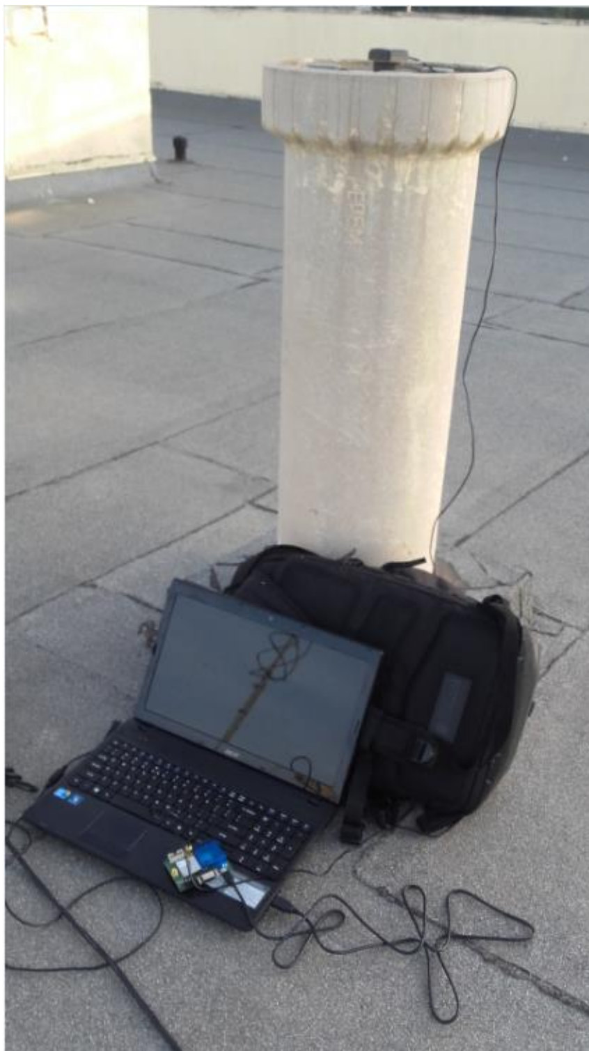
Σχήμα 5.4:Εγκατάσταση Base με γνωστές συντεταγμένες για την αποστολή διορθώσεων στον δέκτη (rover). (Πηγή:Φωτογραφίααπόπεδίο)
