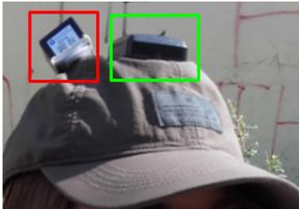
Σχήμα 5.7: Κάπελο με το SPATIAL(κόκκινο περίγραμμα) και με την κεραία του u-blox(πράσινο περίγραμμα) (Πηγή:Φωτογραφία από πεδίο)
