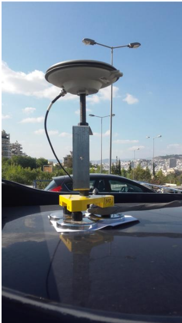
Σχήμα 4.4:Κεραία SPAN (Πηγή: Φωτογραφία από πεδίο) Figure 4.4:Antenna SPAN (Source:Photograph of experiment)
