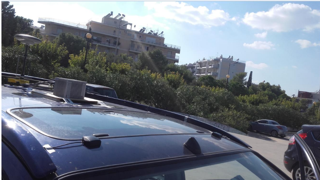
Σχήμα 5.5:Αδρανειακό σύστημα(Πηγή:Φωτογραφία από πεδίο) Figure 5.5:INS system(Source:Photograph of experiment)
