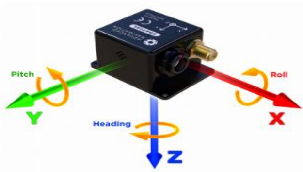
Σχήμα 4.12: Σύστημα SPATIAL(Πηγή:Advanced Navigation) Figure 4.12: SPATIAL system(Source:Advanced Navigation)
