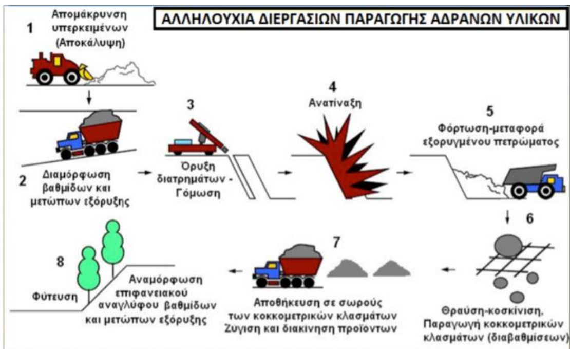
Εικόνα 4: Παραγωγή αδρανών υλικών σε υπαίθριο λατομείο
