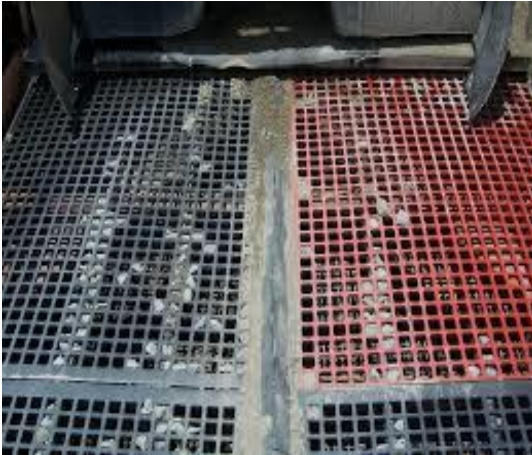
Εικόνα 17: Βούλωμα «φράξιμο» επιφάνειας κόσκινου (blinding)
