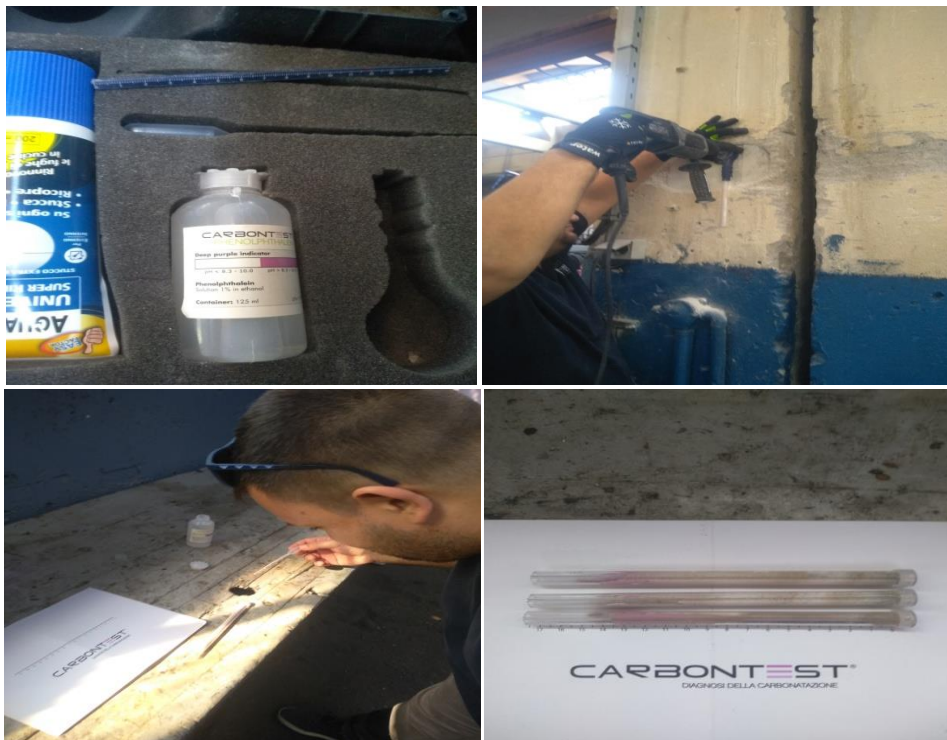
Έλεγχος Ενανθράκωσης Σκυροδέματος
