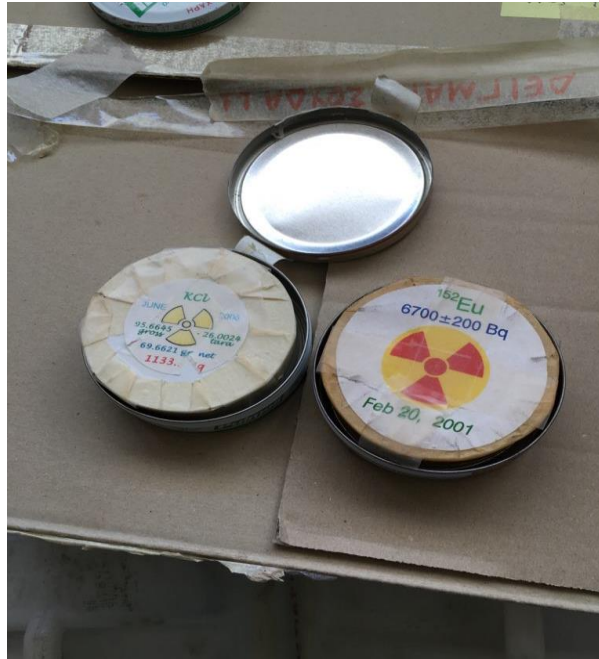
Εικόνα 3.7: Οι πηγές του KCl και ^{152}\text{Eu} για τη βαθμονόμηση των ανιχνευτικών συστημάτων.
