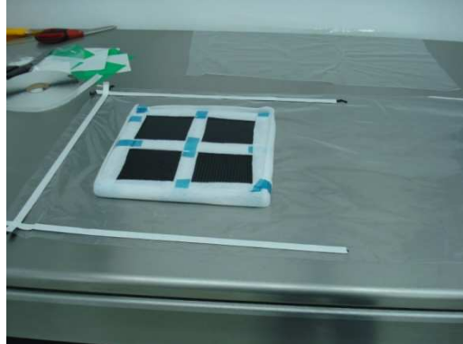
Εικόνα 14: τοποθέτηση κουβέρτας αναπνοής
