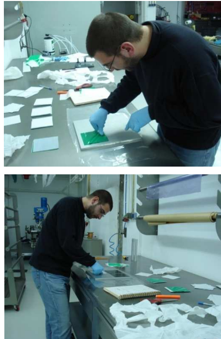
Εικόνα 13: κατασκευή πλακιδίων CFRP
