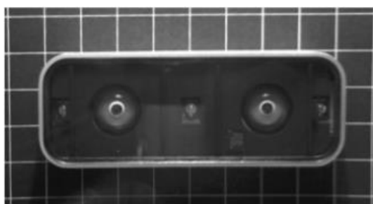
Εικόνα 6-18: το εσωτερικό του αισθητήρα Leap Motion
