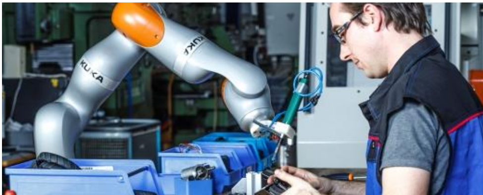
Εικόνα 1-1: Συνεργασία Ανθρώπου-Ρομπότ (A-P) στην εκτέλεση συναρμολόγησης [©Sheffield Robotics, https://www.sheffieldrobotics.ac.uk ]
