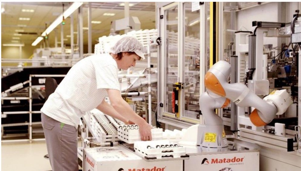
Εικόνα 2-6: Συνεργασία SKODA AUTO και KUKA LBR iiwa [International Federation of Robotics, https://ifr.org ]
