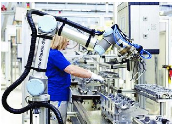
Εικόνα 2-5: Τοποθέτηση βαλβίδων ανάφλεξης σε εργοστάσιο της Volkswagen [Robotiq, https://robotiq.com ]
