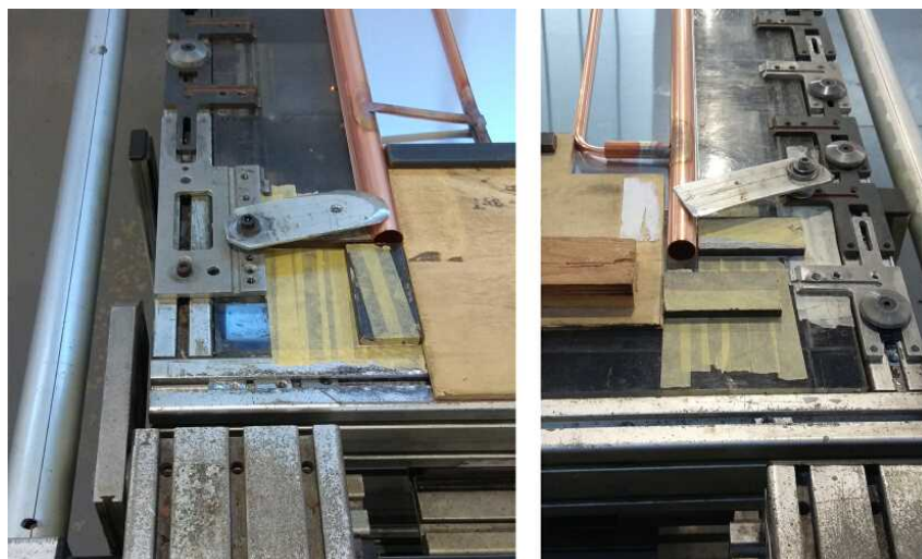
Εικόνα 4: Στοπ τοποθετημένα στις εξόδους των header και πλευρικά τους, και από πάνω οι συγκρατητές ελάσματα σε προϊόν με μαϊανδρο (αριστερή εικόνα: πάνω πλευρά τράπεζας, δεξιά εικόνα: κάτω πλευρά τράπεζας).
