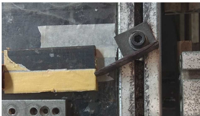
Εικόνα 5: Στοπ σε έξοδο header και ο συγκρατητής του βιδωμένος στο προφίλ αλουμινίου της δεξιάς πλευράς της τράπεζας.
