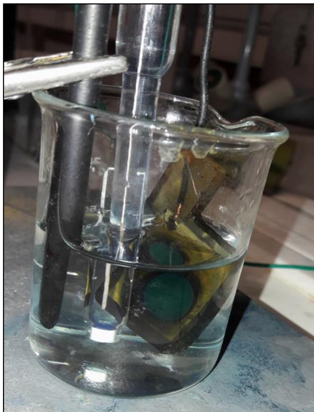
Εικόνα 4-1. Διάταξη τριών ηλεκτροδίων για την πραγματοποίηση του ηλεκτροχημικού πολυμερισμού.
