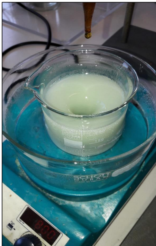
Εικόνα 4-9. Αρχικό διάλυμα συμπολυμερισμού H_2SO_4 – ανιλίνη – SnO_2 όπως εμφανίζεται πριν την προσθήκη του οξειδωτικού παράγοντα και της έναρξης του πολυμερισμού.
