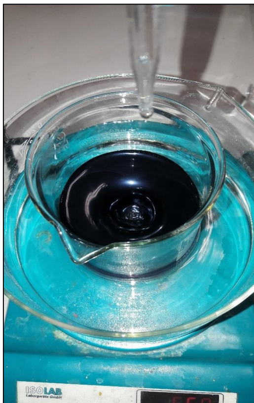
Εικόνα 4.8. Χημικός πολυμερισμός της ανιλίνης – Εικόνα του διαλύματος λίγο πριν το πέρας της διαδικασίας πολυμερισμού.
