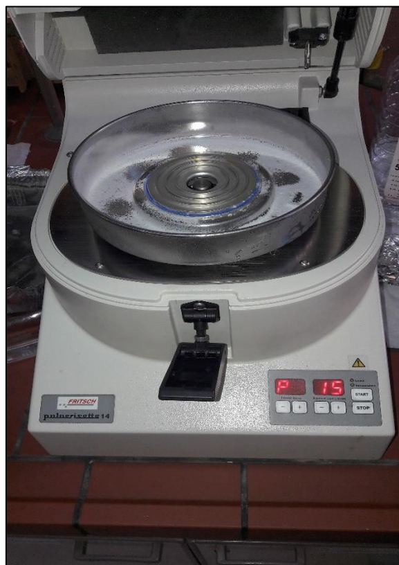
Εικόνα 4-14. Κονιορτοποιητής (pulverizer) μετά τη χρήση του για παραγωγή Teflon υπό μορφή λεπτόκοκκης σκόνης.
