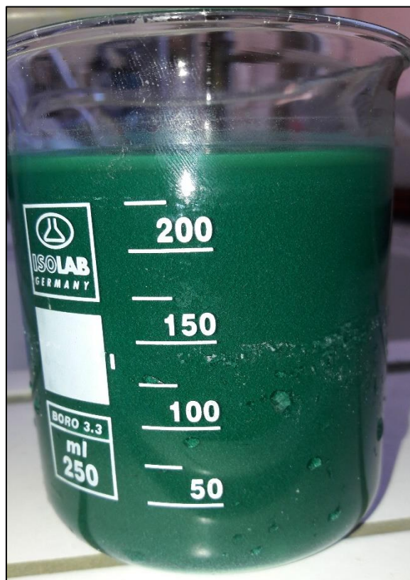
Εικόνα 3-10. Διάλυμα συμπολυμερισμού H_2SO_4 – πολυανιλίνη – SnO_2 όπως εμφανίζεται μετά το πέρας της διαδικασίας του πολυμερισμού.
