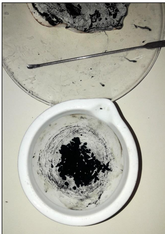
Εικόνα 4-12. Σκόνη πολυανιλίνης μετά το πέρας της διαδικασίας ξήρανσης και πριν τη διαδικασία της λειοτρίβησης.
