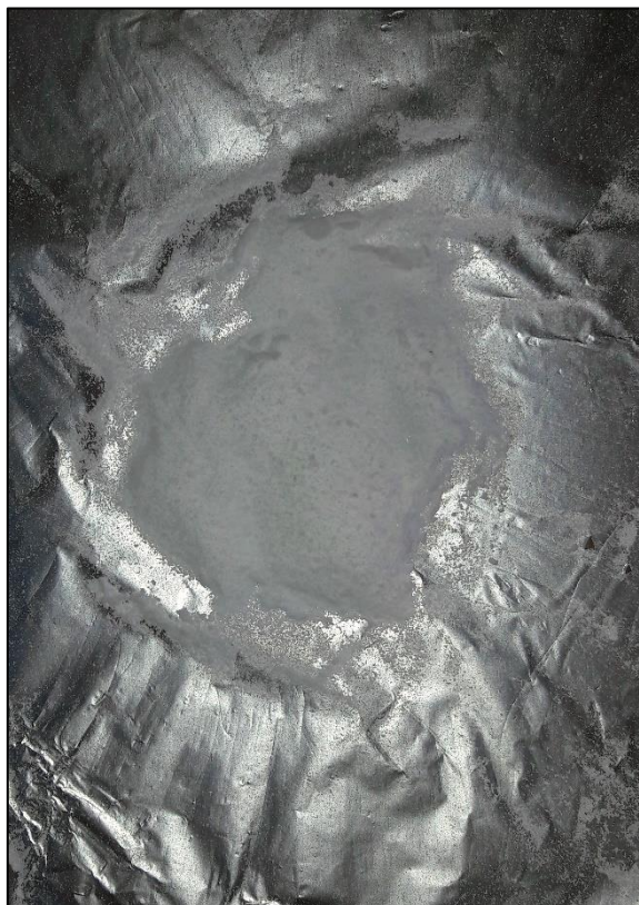
Εικόνα 4-15. Λεπτόκοκκη σκόνη Teflon μετά τη διαδικασία της κωνιορτοποίησης.
