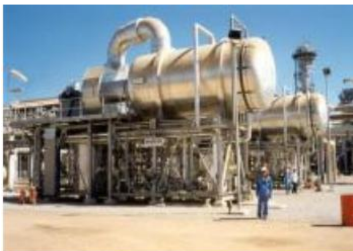
Εικόνα 1.3 Εγκατάσταση συμπίεσης ατμού, VC. (Κάραλης Γ., 2011)
