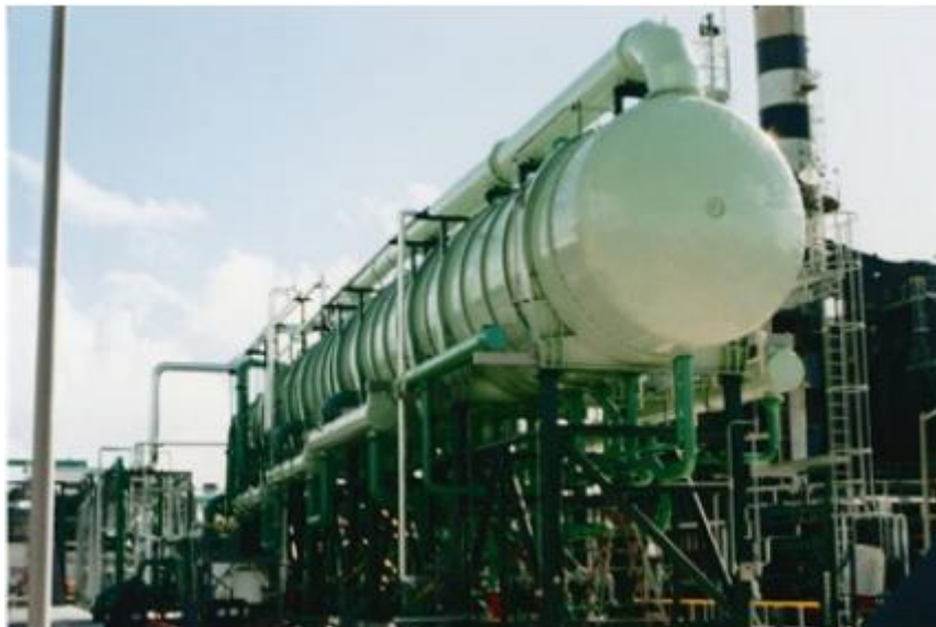
Εικόνα 1.2 Εγκατάσταση με πολυβάθμια εξάτμιση. (Κάραλης Γ., 2011)
