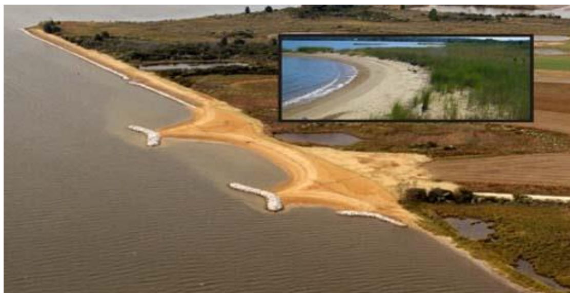
Σχήμα 16. Εξέλιξη ακτογραμμής 6 χρόνια μετά την κατασκευή έξαλων κυματοθραυστών (Shoreline Studies Program)
