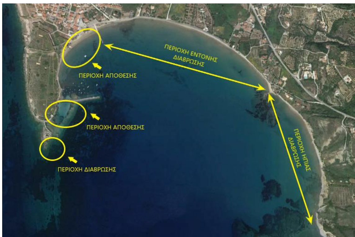
Σχήμα 33. Χωρική αποτύπωση των περιοχών διάβρωσης και απόθεσης ιζήματος
