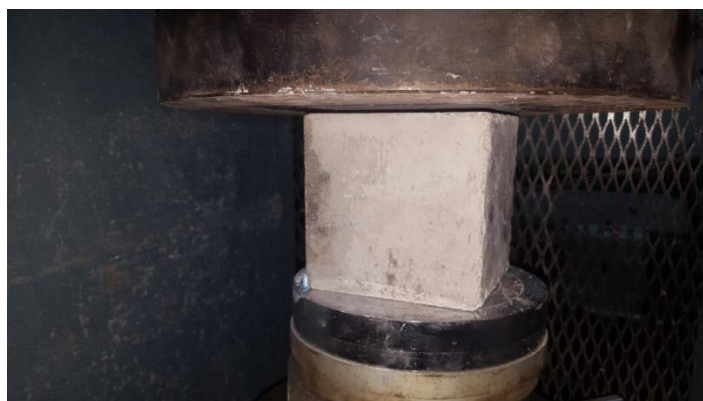
Εικόνα 18: Διάταξη δοκιμής σε μονοαξονική θλίψη για τον προσδιορισμό της θλιπτικής αντοχής f_c
