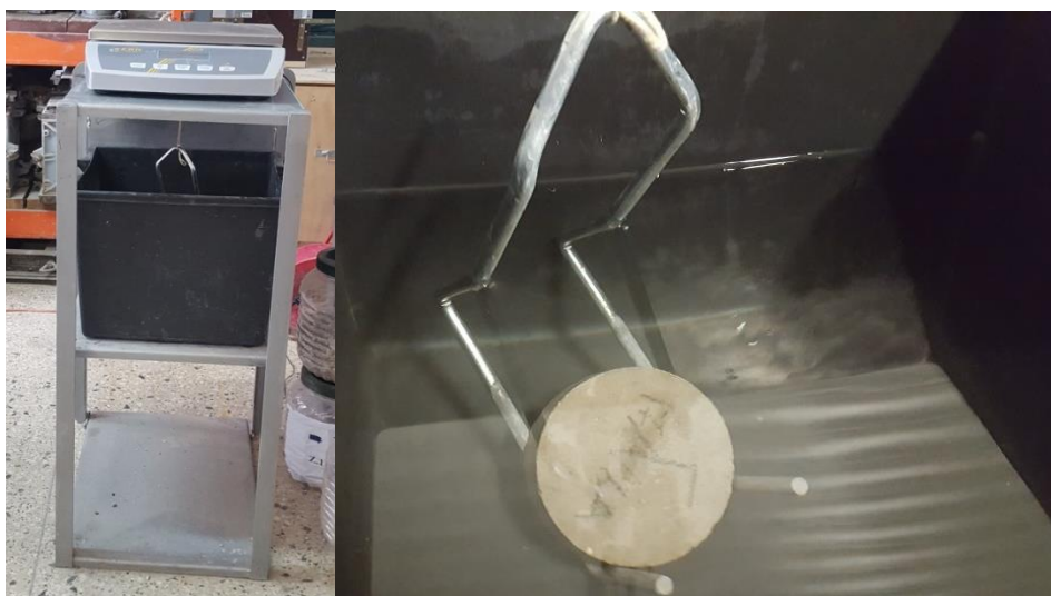
Εικόνα 20: Μέτρηση μάζας υπό άνωση (M imm )
