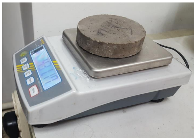
Εικόνα 19: Μέτρηση μάζας επιφανειακώς στεγνού δοκιμίου (M sat )
