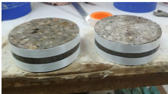
Εικόνα 23: Δοκίμια σκυροδέματος με μονωτική ταινία Teflon
