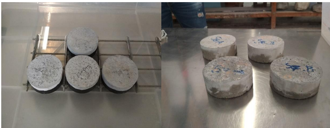
Εικόνα 22: Δοκίμια κατά την διάρκεια και με το πέρας του πειράματος της τριχοειδούς απορρόφησης
