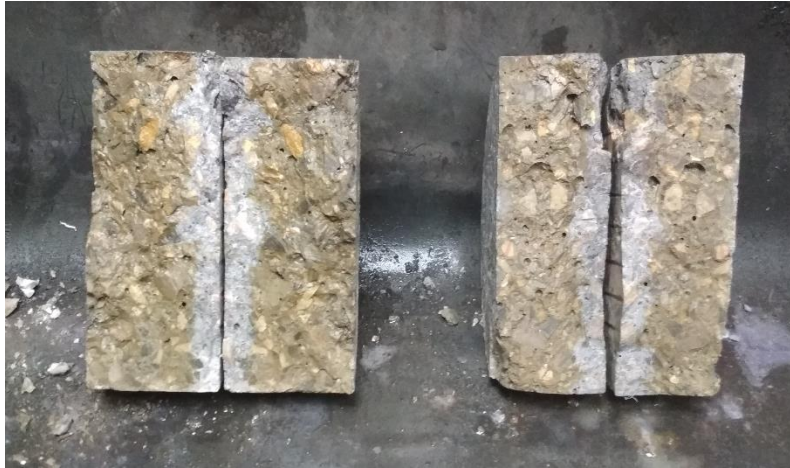
Εικόνα 27: Δοκίμια μετά τη διάρρηξη και τον ψεκάσμο με AgNO_3
