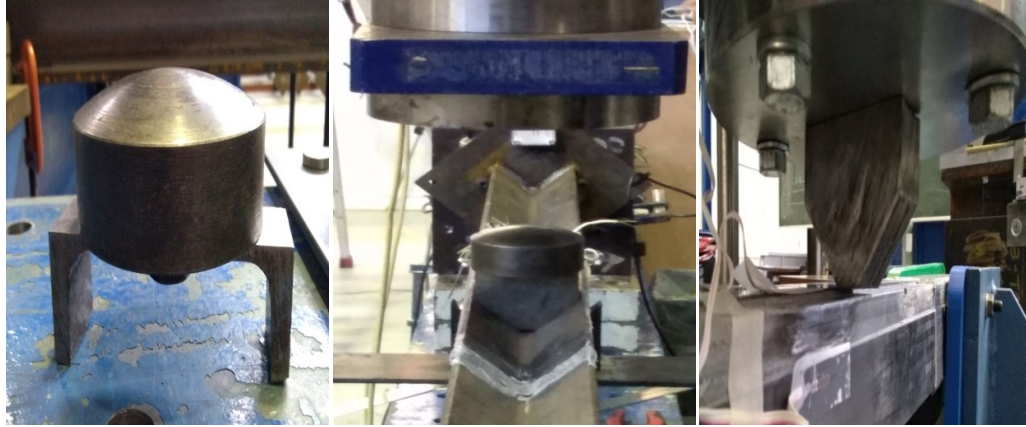
Εικόνα 2.17: Διατάξεις που χρησιμοποιούνται για την άσκηση φορτίου στα εξεταζόμενα δοκίμια B-T1-V, B-T2-V/B-T2-V2 και B-T1-LI αντίστοιχα.
