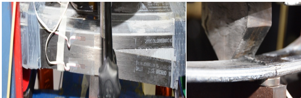
Εικόνα 2.36: Α: Αστοχία πλάγιου πέλματος Β: Αστοχία πάνω πέλματος
