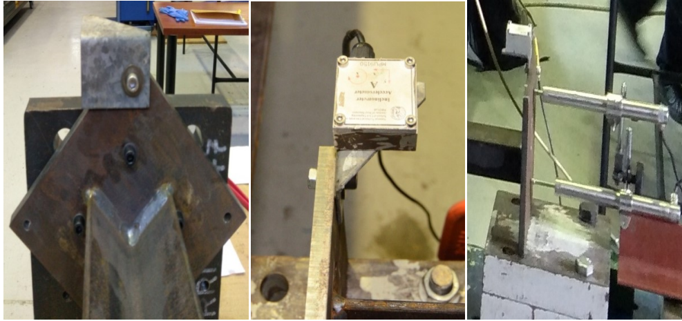
Εικόνα 2.21 Α: Διάταξη στην οποία τοποθετείται ο περιστροφικός μετασχηματιστής Β: Περιστροφικός μετασχηματιστής Γ: Οριζόντιοι γραμμικοί αισθητήρες
