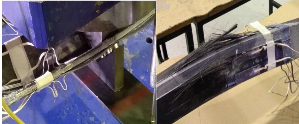
Εικόνα 2.25: Α: Αποκόλληση CFRP Β: Αστοχία ινών CFRP
