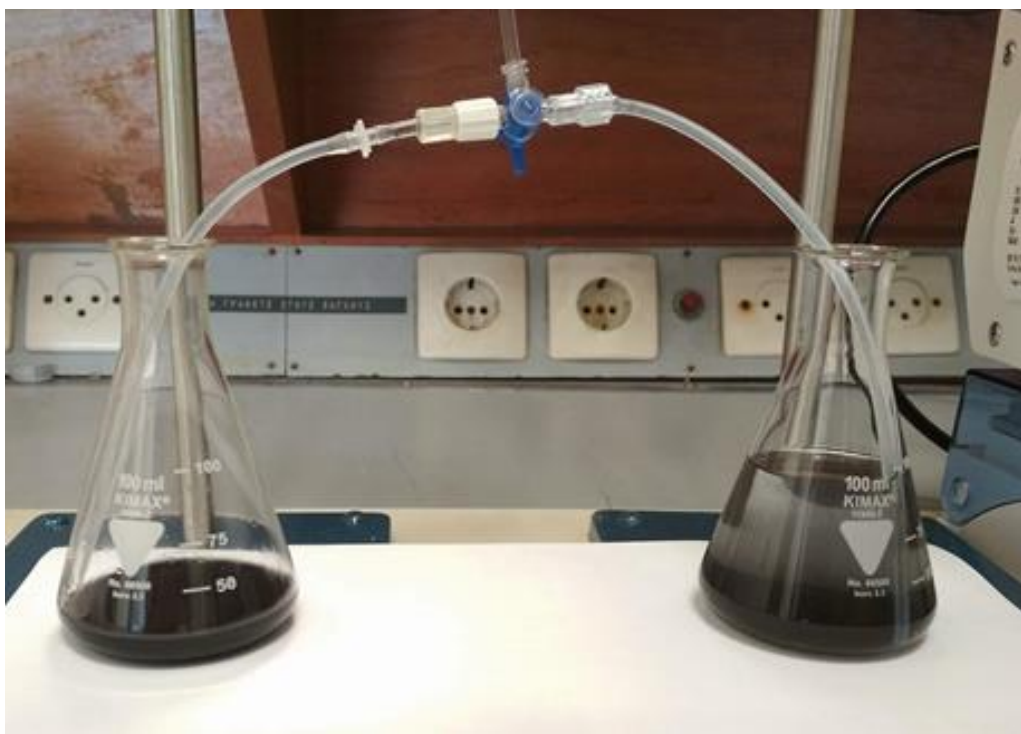
Σχήμα 37: Συλλογή μαγνητικών σωματιδίων σε ξεχωριστές φιάλες
