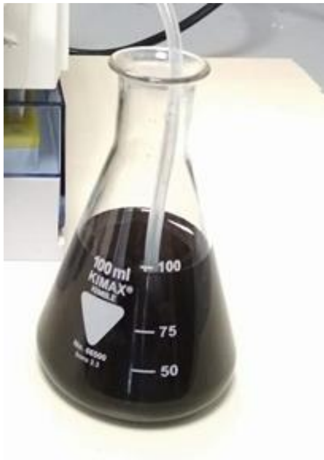
Σχήμα 27: Αλκοολικό διάλυμα με μαγνητικά σωματίδια
