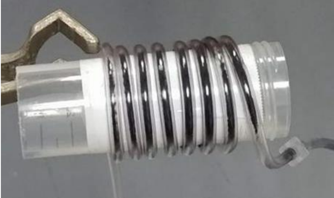
Σχήμα 35: Αφαίρεση μαγνητικού πυρήνα
