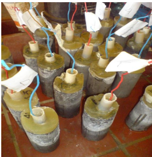
Εικόνα 16- Δοκίμια όπου φαίνονται οι εναποθέσεις των αλάτων στην επιφάνειά τους
