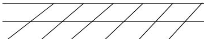
Σχήμα 1 – Σύμανση χάλυβα κατηγορίας B500A με δύο σειρές νευρώσεων
