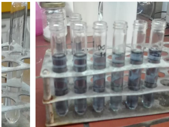
Εικόνα 33: δείγμα πριν το υδατόλουτρο (αριστερά) και δείγματα μετά τα 30min στο υδατόλουτρο (δεξιά)
