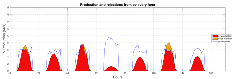
Διάγραμμα 4.3 Καμπύλη setpoint και παραγωγής φωτοβολταϊκών για την εβδομάδα 12-18 Απριλίου (Πολιτική 5 στα περιθώρια, 10 MW περικοπτόμενα ΦΒ, 5 MW μπαταρία 4h εκφόρτισης)
