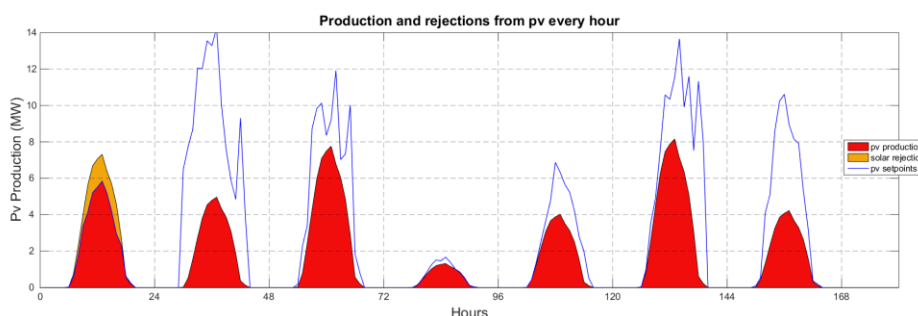
Εικόνα 3. 11 Καμπύλη setpoint και παραγωγής φωτοβολταϊκών για την εβδομάδα 12-18 Απριλίου (Πολιτική 4)
