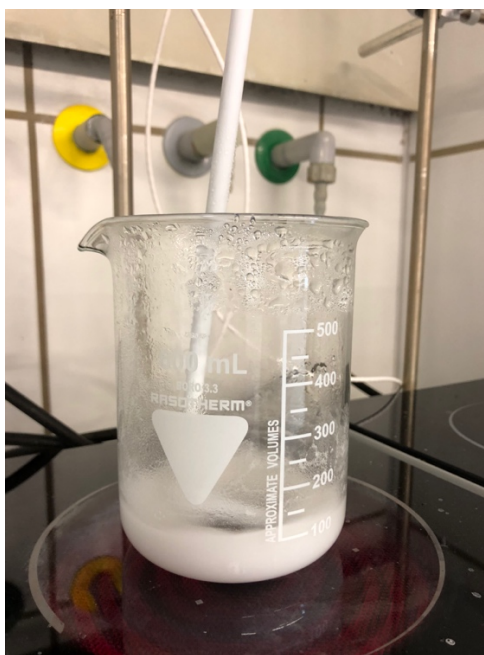
Εικόνα 25: Ίζημα ανθρακικού λιθίου
