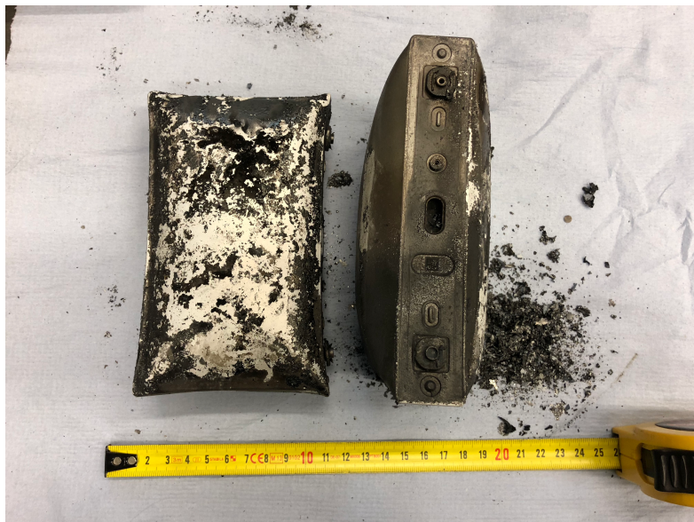
Εικόνα 17: Κελιά μπαταρίας μετά την πυρόλυση
