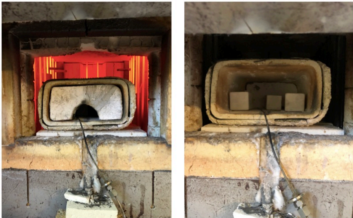
Εικόνα 20: Οι 3 χοάνες και ο σωλήνας αερίου μέσα στον φούρνο.
