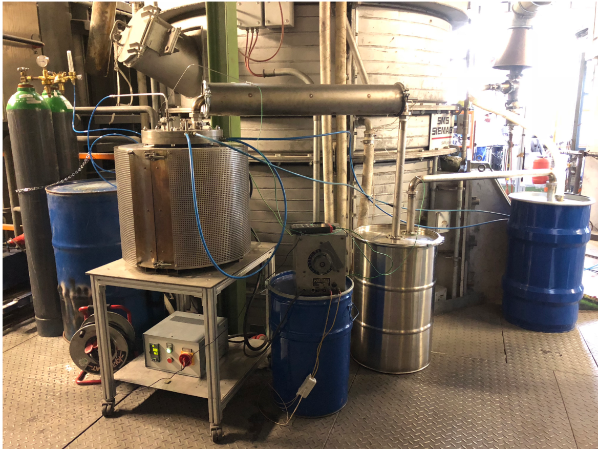
Εικόνα 12: Εξοπλισμός πειράματος πυρόλυσης
