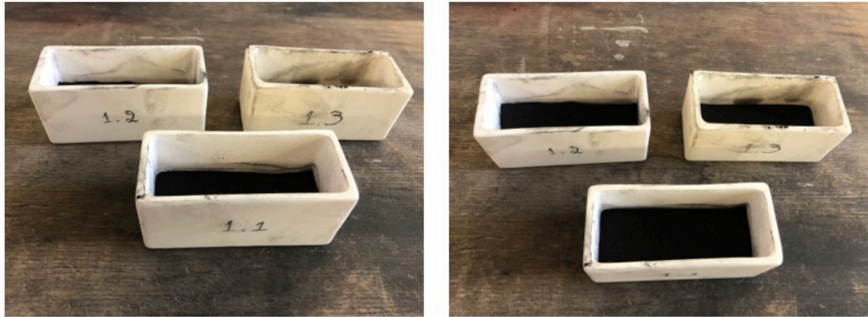
Εικόνα 21: Χοάνες με ενεργή σκόνη πριν και μετά την ενανθράκωση
