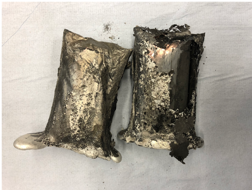
Εικόνα 19: Λιωμένα κελιά μπαταρίας, Πείραμα 7ο
