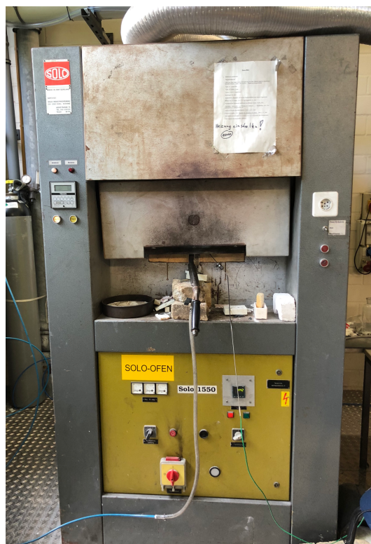
Εικόνα 22: Φούρνος πειράματος ενανθράκωσης
