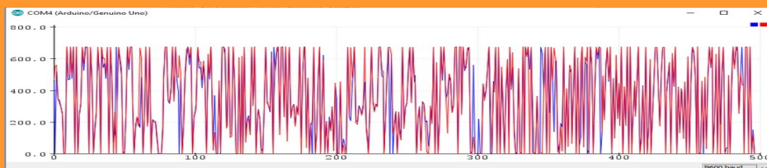
Σχήμα 47: Διάγραμμα της απόκρισης των δύο υδροφώνων (HF1, HF2), με κινητήρα δόνησης
