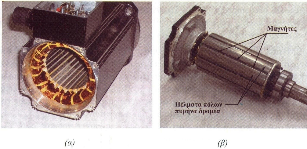
Σχήμα 2.27 Τριφασική 6-πολική ΣΜ με μαγνήτες εφαπτομενικής διεύθυνσης μαγνήτισης στο εσωτερικό του δρομέα: (α) στάτης (β) δρομέας
