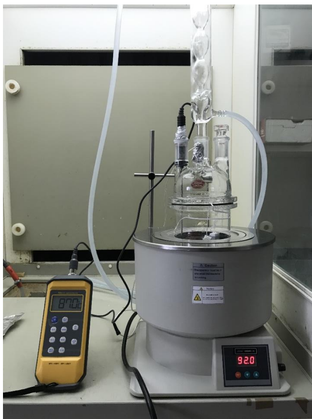
Εικόνα 3.2. Πειραματική διάταξη που χρησιμοποιήθηκε για την ανάπτυξη των νανοραβδίων
