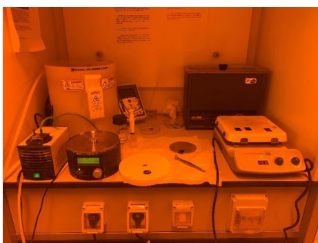
Εικόνα 3.1. Εξοπλισμός που χρησιμοποιήθηκε για τη διαδικασία επίστρωσης του στρώματος πυρήνωσης.
