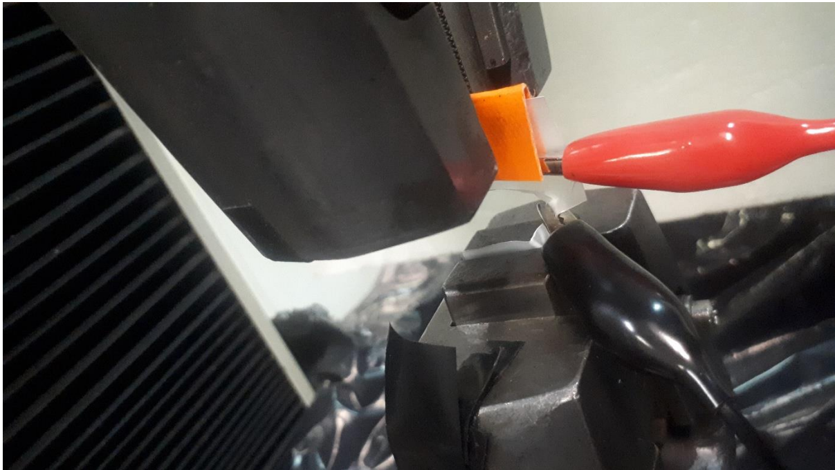
Figure 8. Μέτρηση σε δοκίμιο, στην στιγμή της θραύσης μεγάλου πάχους. Σε αυτήν την δοκιμή προέκυψε το παρακάτω σήμα.
