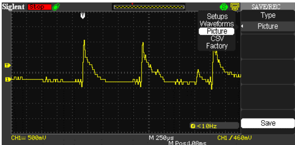
Figure 9. Το ηλεκτρικό σήμα, που παρουσιάστηκε στην παραπάνω δοκιμή, είναι εντυπωσιακό και τεράστιο. Κατά απόλυτη τιμή είναι 1Volt αλλά λαμβάνοντας υπόψη τον υψηλό θόρυβο, μπορεί να φτάνει και το 1.5 Volts.
