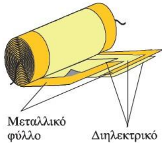
Figure 6. Εικόνα 5.40 από το βιβλίο "Φυσική, ομάδα προσανατολισμού θετικών σπουδών, Β' Γενικού λύκειο" των "Ι. Βλάχο et.al." Εικόνα που περιγράφει έναν κλασικό τύπο πυκνωτή, δύο φύλλα αγωγού χωρισμένα από ένα διηλεκτρικό (ή μονωτή).
