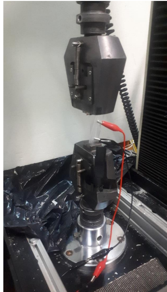
Figure 6. Η δοκιμή εφελκυσμού ενός «tapered» beam μικρού πάχους.
