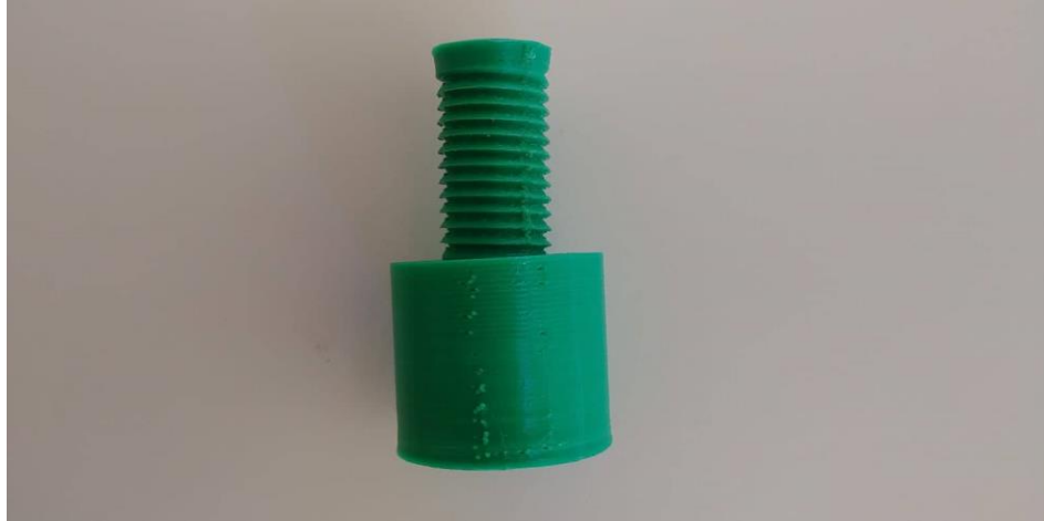
Εικόνα 8.1 Πρώτη δοκιμή με χρήση μεθόδου FDM (αδυναμία συναρμογής)
