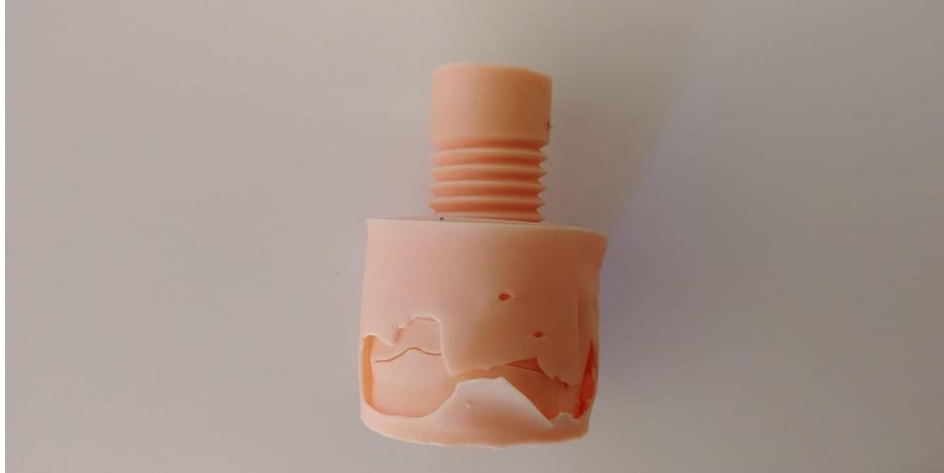
Εικόνα 8.3 Τρίτη δοκιμή με μέθοδο SLA και αστοχία εξωτερικού περιβλήματος
