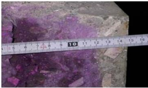
Εικόνα 6: Εκτίμηση βάθους ενανθράκωσης σκυροδέματος μετά από ψεκάσμο με διάλυμα φαινολοφθαλεΐνη
