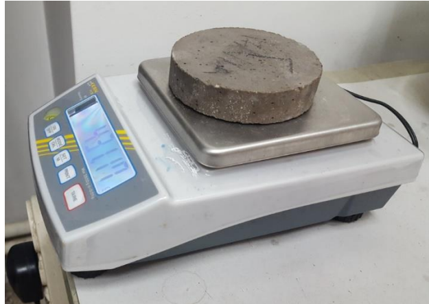
Εικόνα 19: Μέτρηση μάζας επιφανειακά στεγνού δοκιμίου (M sat )
