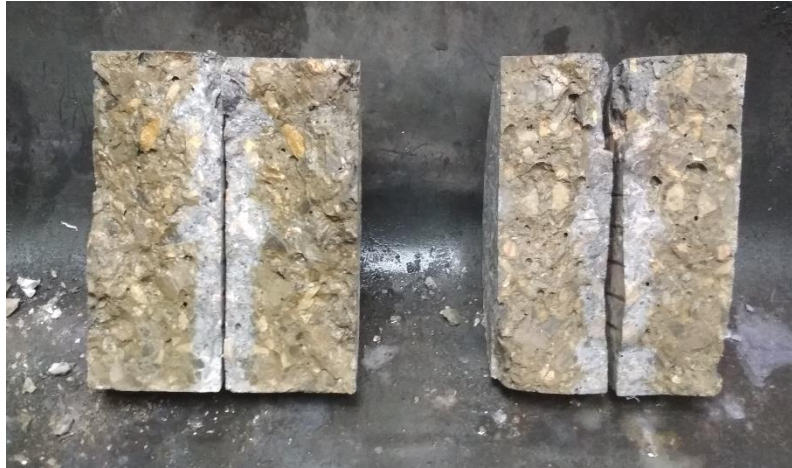
Εικόνα 27: Δοκίμια μετά τη διάρρηξη και τον ψεκασμό με AgNO_3
