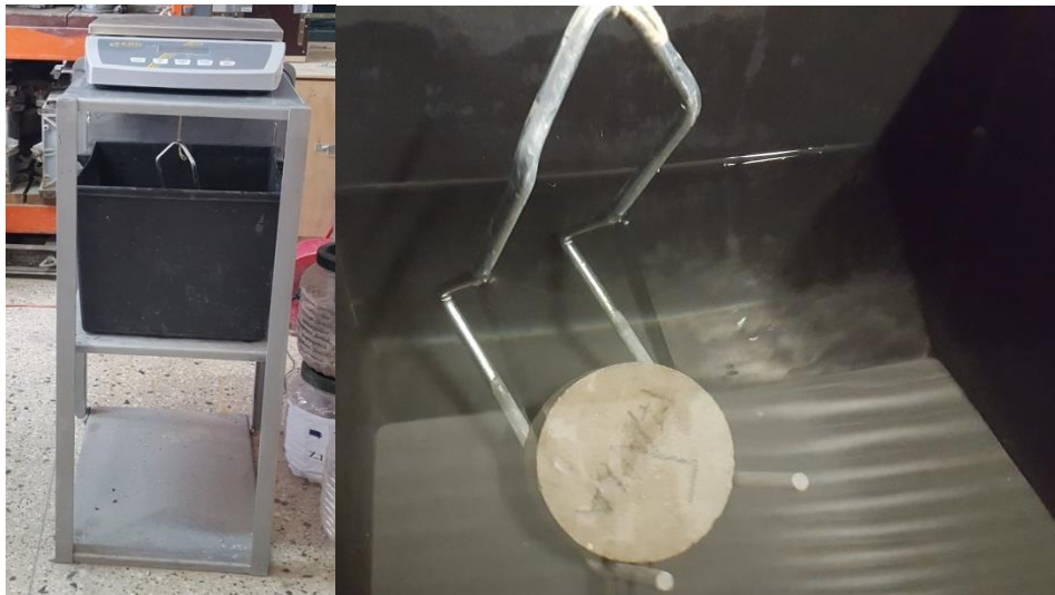
Εικόνα 20: Μέτρηση μάζας υπό άνωση (M imm )
